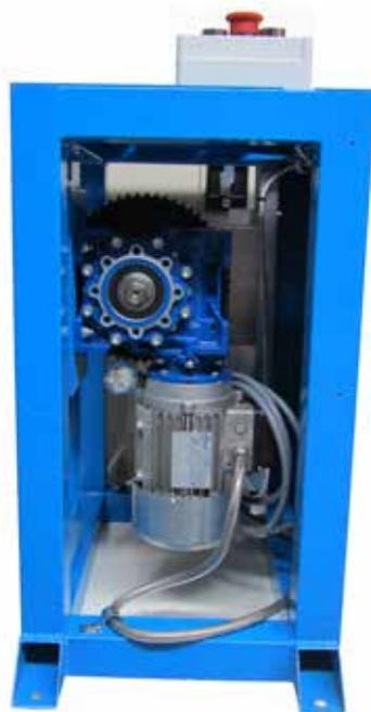
En plus, on a installé sur le motoréducteur un inverseur (non livré par Motovario) avec alimentation monophasé, dans le but de contrôler le mouvement de l'élévateur et protéger l'opérateur contre les surcharges électriques.
