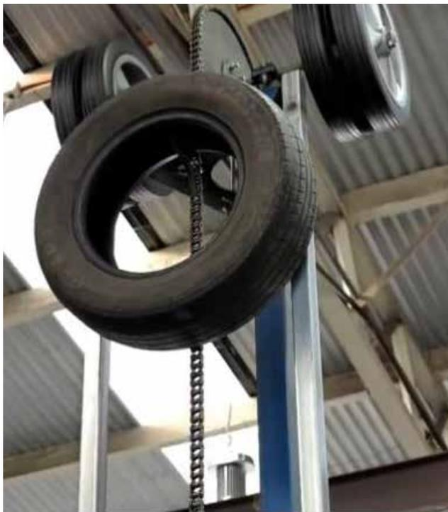
Le couple requis en sortie du réducteur est proportionnel à la masse totale que l'élévateur pourrait soulever à pleine charge, et donc a une valeur indicative de  $M_2 = 60 \text{ Nm}$ . A partir de ces données il est possible de déterminer la puissance nécessaire pour le fonctionnement de la machine (0,25 kW).
